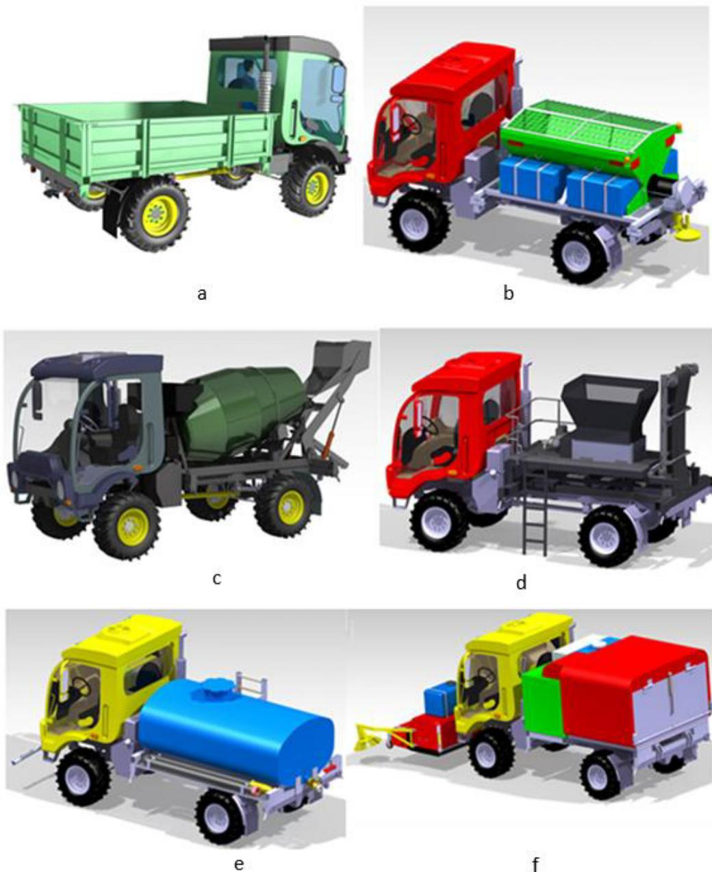
Obr. 4: Vizualizácia komunálneho vozidla: a) s valníkovou nadstavbou, b) s posýpacím zariadením, c) s domiešavacím zariadením, d) s drvičom, e) s cisternou a oplachom, f) s nadstavbou vysávača s príavným zametacím zariadením
