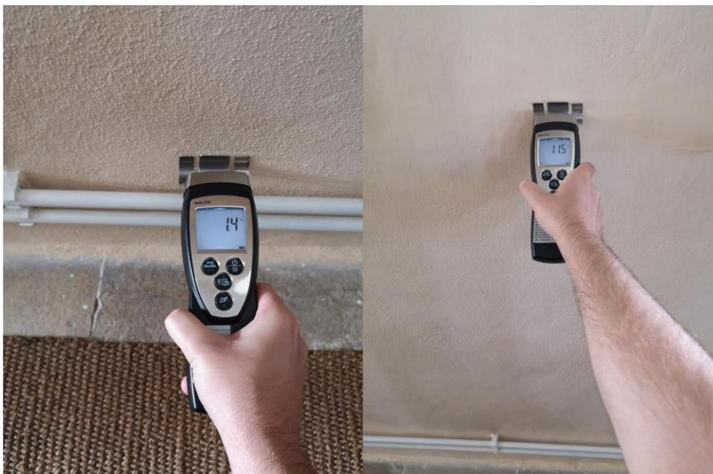
Obr. 3: Vlhkosť a) na sanačnej omietke, b) nad úrovňou sanačnej omietky [autor]
