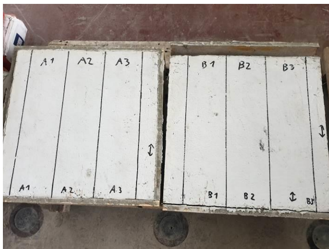
Obr. 3: Skúšobné vzorky s riadeným usmernením vlákien pred rezaním (foto autori)
