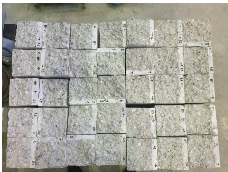
Obr. 6: vzorky skúšané na C-MOD (foto autori)
