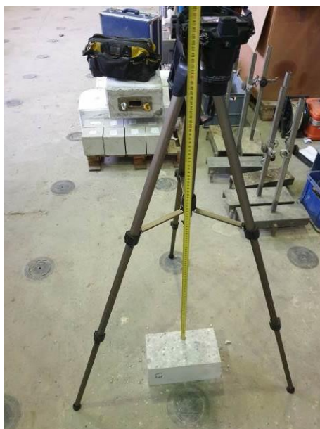
Obr. 5: Metóda identického snímkovania (foto autori)
