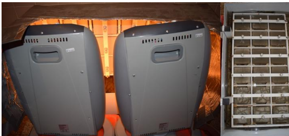
Obr. 1: Zkušební zařízení pro realizaci zkoušky dle ČSN 73 2581
