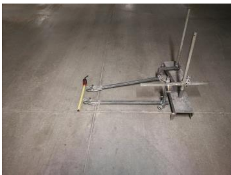
Obr. 10: Meranie deformácií (pohybov) dosiek podlahy
