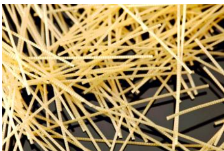
Obr. 2: Dvojzložkové makrovlákno Concix vyvinuté v spolupráci s EMPA
