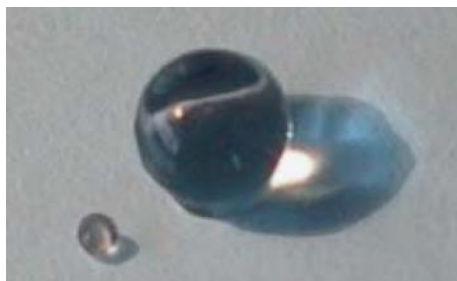
Obr. 2: Zrná SAP v suchom a nasiaknutom stave [1]
