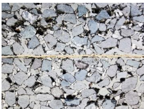
Obr. 5: Rez vrstvou Rodal® – vyplnenie dutín cem. maltou
