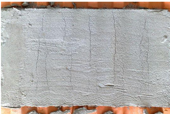
Obr. 9: Jednoduchý dôkaz objemových zmien malty významu dôsledného vyplnenia škár muriva
